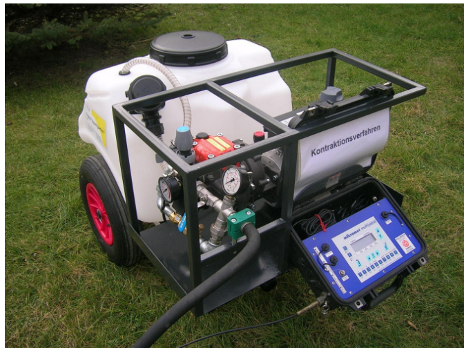
Modulares Prüfsystem für W101 Rohrleitungsprüfpumpe mit separatem Prüfgerät. Protokolldrucker separat oder eingebaut.
